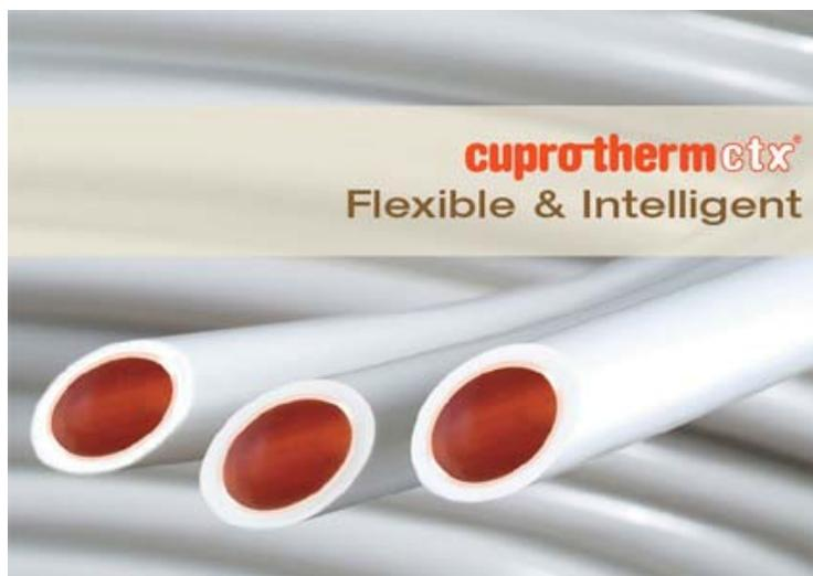
Трубы Wieland **cuprotherm CTX®** - это медные трубы с PERT-оболочкой. В результате комбинации меди и пластика достигается высокая механическая прочность с допустимыми рабочими давлениями **свыше 30 бар** даже при высоких температурах, труба отлично сгибается во всех направлениях. Пластиковая оболочка надежно защищает медные трубы от воздействий агрессивных сред, снижает теплопотери и уменьшает шум. Трубы cuprotherm CTX® почти на 50% легче обычных медных труб.
